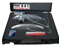
Steer- und Schwinge-Check für alle Motorroller. Lieferung in Spezialkoffer inkl. aller benötigten Teile.
